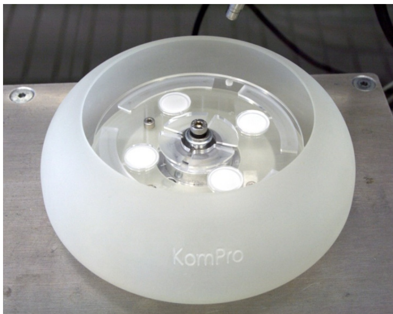
Abbildung 4 Auffanggefäß zur kontinuierlichen Entsorgung der prozessierten Probe von der zentrifugal mikrofluidischen Plattform. Zusätzlich bietet das Auffanggefäß einen Abfluss (im Bild nicht gezeigt), um größere Volumina abzuleiten und kontrolliert zu Entsorgen. Zur Veranschaulichung wurde eine LabDisk inkl. Filter in das Auffanggefäß und den Messplatz eingebaut.
