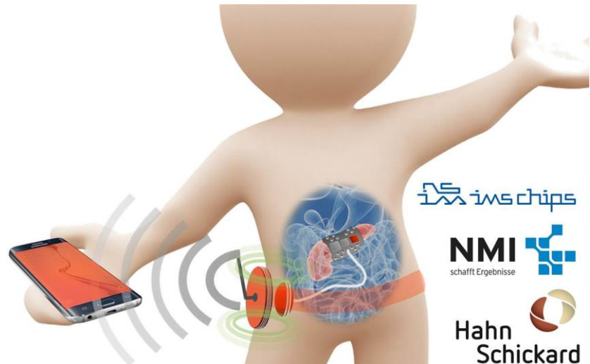
Abb. 1: Schematische Darstellung des intelligenten Implantatsystems bestehend aus einer an der Bauchspeicheldrüse befestigten, flexiblen Elektrodenmatte, einer direkt unter der Haut implantierten Powermanagement- und Datenkommunikationsboje, einer am Gürtel getragenen externen Einheit und dem Android Device zur Datenanzeige und Funktionssteuerung.
