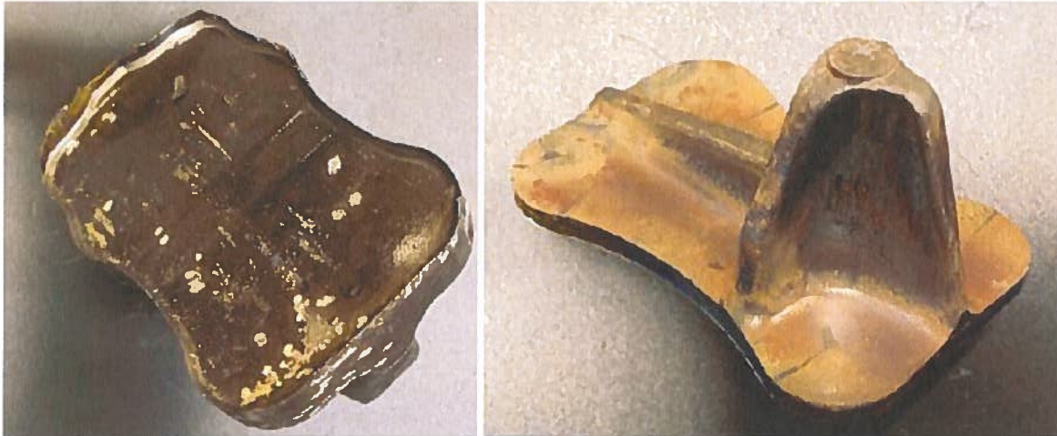
Abbildung 1 Links: zeigt das Werkzeugteil 036851 mit dem aus dem Schmiedeprozess zurück gebliebenen Grat. Rechts: zeigt das Werkzeugteil 33000 mit dem aus dem Schmiedeprozess zurück gebliebenen Nocken.
