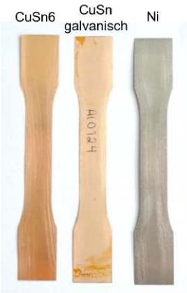
Abbildung 25: Relaxationsversuche: TiraTest 2810, Probengeometrie, Probeneinspannung
