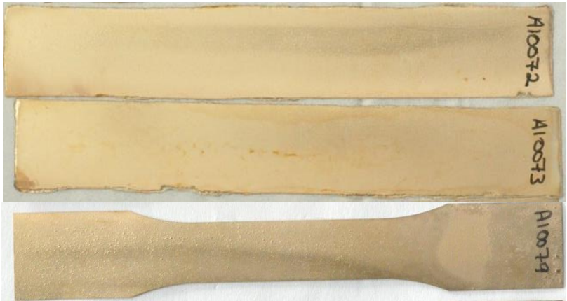
Abbildung 5: auf Al-Blech galvanisch abgeschiedene Bronzefolien (oben mit Al-Substrat, Mitte: nach Al-Entfernung, unten: nach Laserzuschnitt für Zugversuche)
