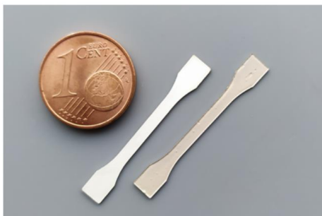
Abbildung 30: Gesinterte Zugstäbe aus Silberpaste, Messergebnisse Zugversuch für unterschiedliche Sinterparameter
