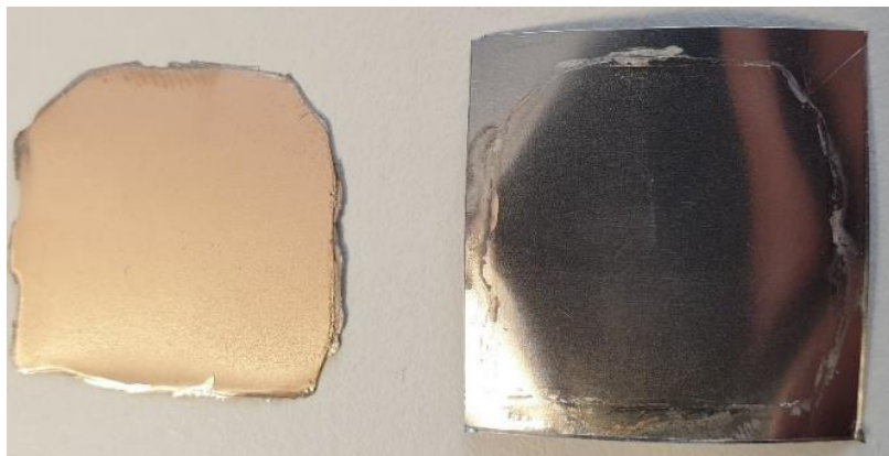
Abbildung 6: Auf vorbehandeltem Edelstahl galvanisch hergestellte, trennbare CuSn-Folie
