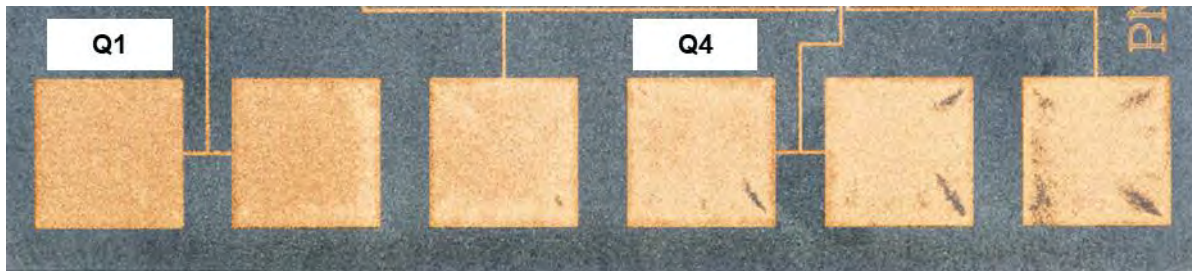
Abbildung 45: Übersicht von Fehlerbildern bei verkupferten quadratischen Pads auf LCP.
