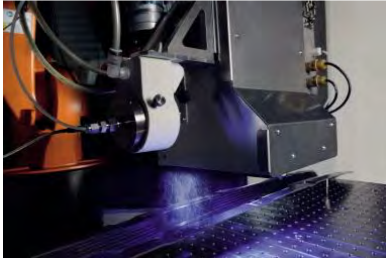
Abbildung 6: BonNDTinspect© System zur Bewertung des Benetzungsverhalten von Oberflächen.
