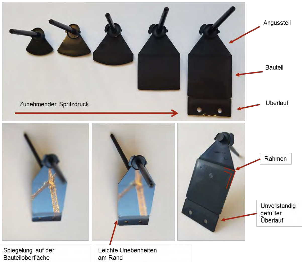
Abbildung 15: Spritzguss-Füllstudie für XANTAR und genauere Betrachtung der erhaltenen Bauteile.
