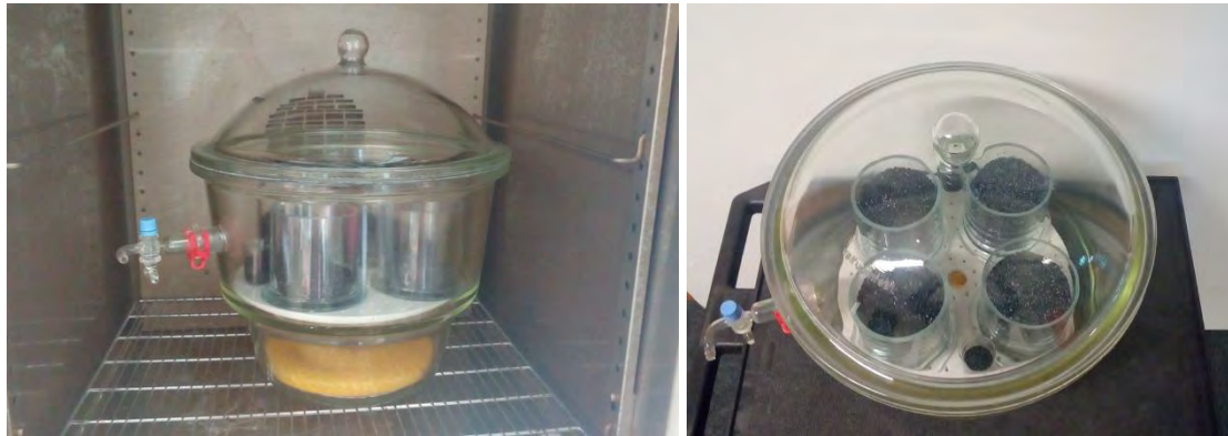
Abbildung 19: Trocknung der Granulate im Exsikkator im Ofen bei 50 °C.
