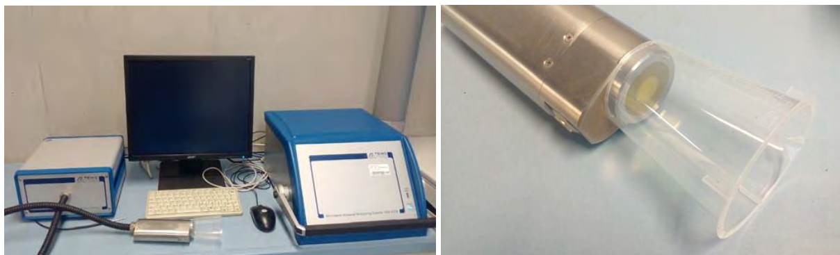
Abbildung 21: Microwave Moisture Measuring System MW4310 mit dem planaren, modifizierten MW-Sensor SLC-043-UiS.
