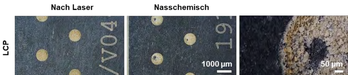
Abbildung 32: Lichtmikroskopische Aufnahmen von LCP nach dem Lasern und nach der nasschemischen Reinigung derselben Probe.
