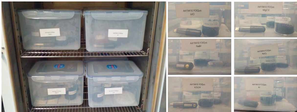
Abbildung 20: Auslagerung der Granulate bei eingestellten relativen Luftfeuchten.
