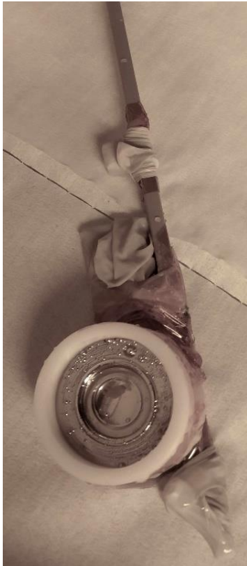
Abbildung 32: Die Bauteilhalterung ermöglicht die elektrische Ankontaktierung.
