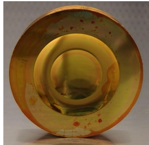
Abbildung 22: Links: gekrümmter UPM gedrehter Masterrohling ohne Lackschicht. Rechts: Masterrohling mit aufgeschleuderter Antireflexbeschichtung und Photoresist.
