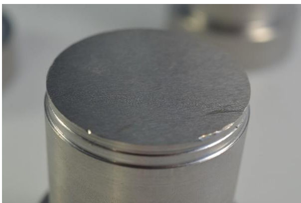
Abbildung 13: Der Werkzeugstempel vor und nach der Beschichtung mit Nickelphosphor und anschließender Bearbeitung mittels Flycutting.
