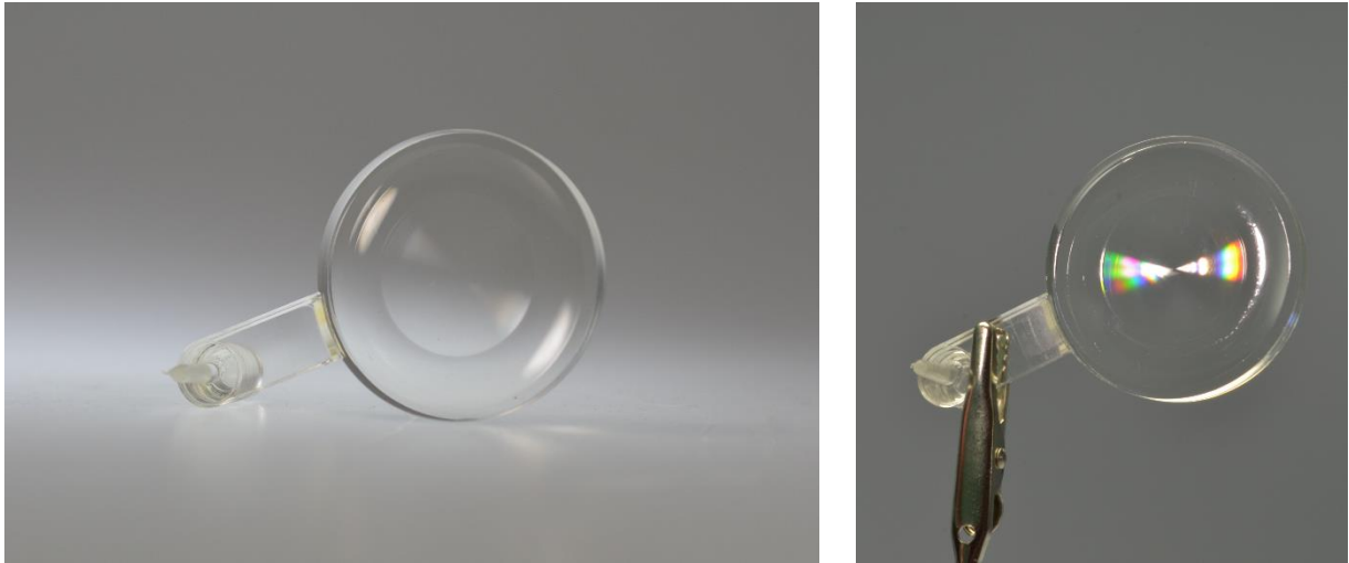
Abbildung 35: Die mittels Spritzprägen hergestellte Kunststofflinse.
