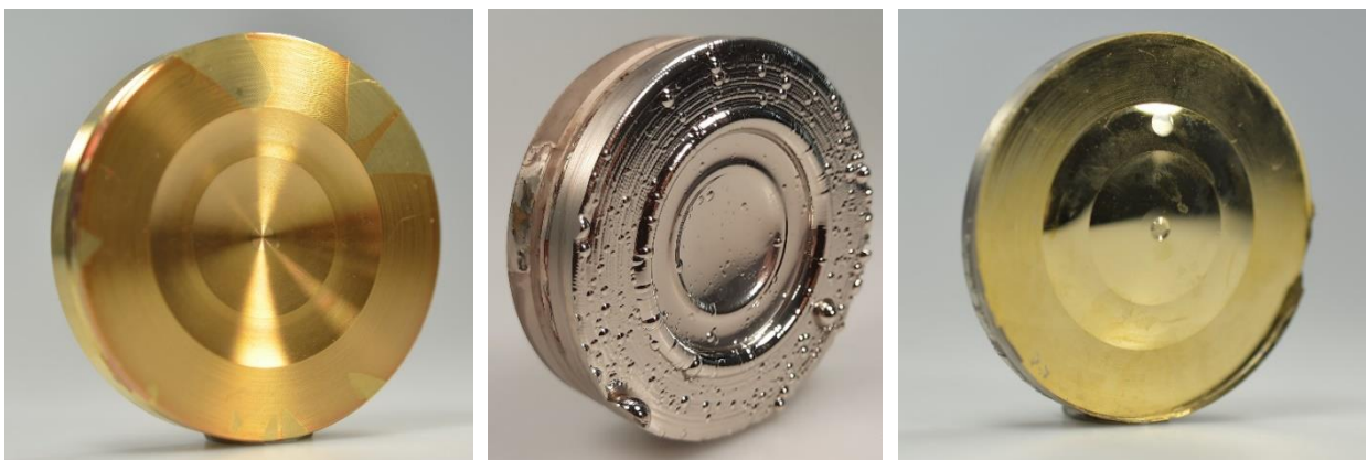
Abbildung 31: Nach Auftrag und Strukturierung des Fotolacks konnte eine Nickelschicht auf dem Bauteil abgeschieden werden. Diese wurde im nächsten Schritt mechanisch entfernt. Die Struktur konnte erfolgreich auf das Nickelbauteil übertragen werden.
