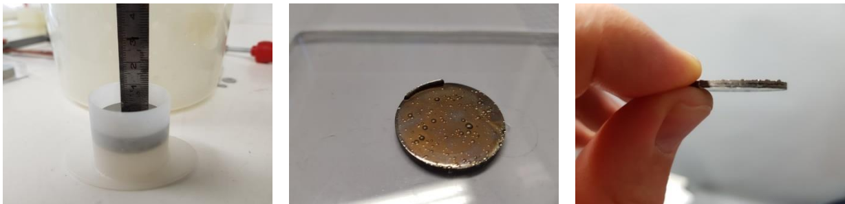
Abbildung 29: Nach dem Versenken der Struktur in dem Zylinder konnten die Überwachungen stark reduziert werden. Jedoch waren mehr Lunker an der Oberfläche zu beobachten.
