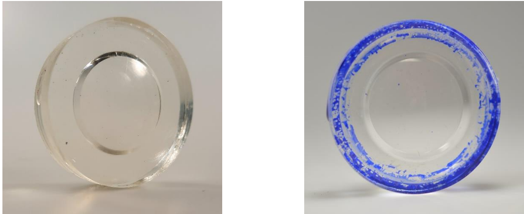
Abbildung 37: Mit Hilfe von eingefärbtem Klebstoff konnte nachgewiesen werden, dass kein Klebstoff auf die Funktionsflächen dringt.
