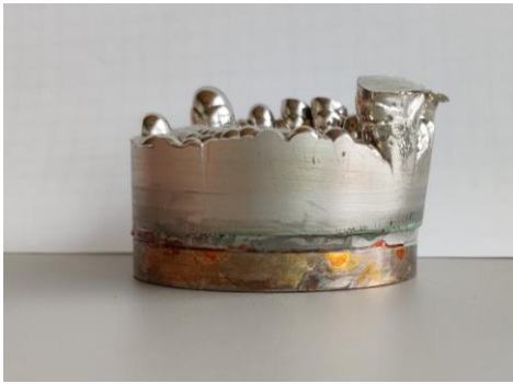
Abbildung 33: Links: Die Nickelschicht auf dem Messingmaster ist ca. 9 mm aufgewachsen. Rechts: Nach dem Entformen und dem Drahterodieren ist der Einsatz vorbereitet zum Einbau in das Spritzprägewerkzeug
