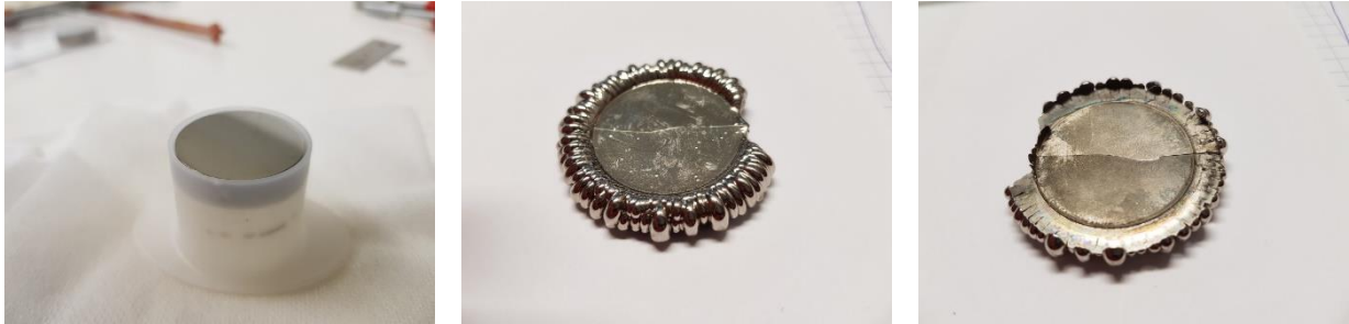
Abbildung 28: Die Abformung des einfachen Bauteils war nur schwer zu realisieren, da Überwachungen an den Rändern zu Schwierigkeiten bei der Entformung führten.
