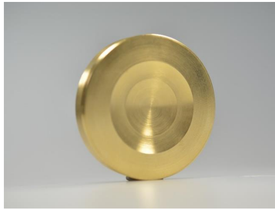
Abbildung 16: Gedrehter Linsenrohling ohne optische Oberfläche für die Durchführung von Vorversuchen zum Belacken und Strukturieren.
