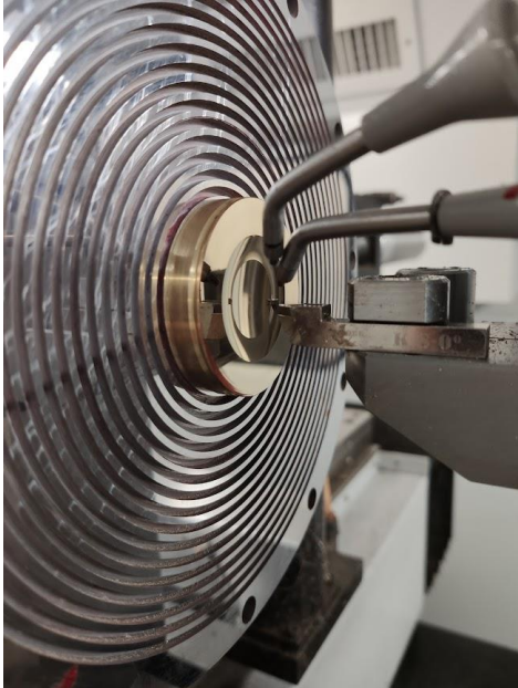
Abbildung 17: Der Messingrohling wird mittels Vakuuman-saugung gelagert, während mit einem Diamantdrehmeisel die Oberfläche bearbeitet wird.
