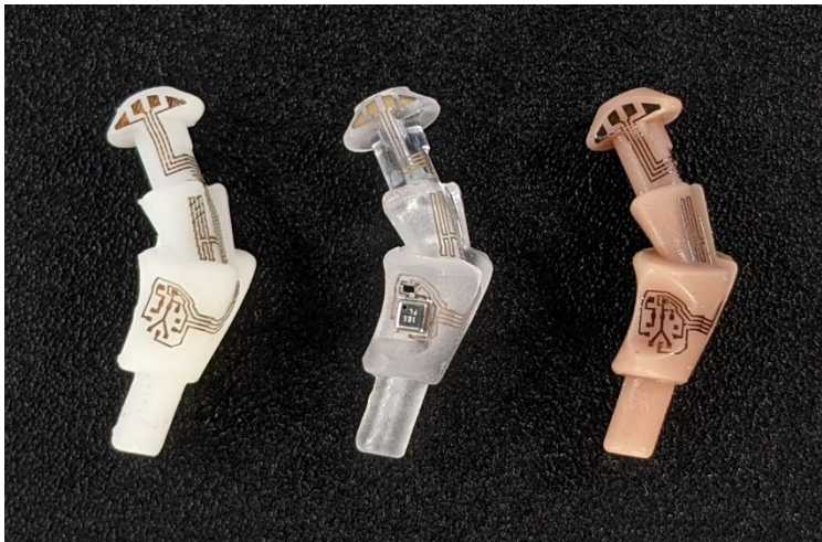
Abbildung 20: Funktionalisierte Otoplastikkörper in 3 unterschiedlichen Ausführungen: Prodways PlastCure Rigid 10500 (links) und Dreve FotoTec DLP A (mitte und rechts).
