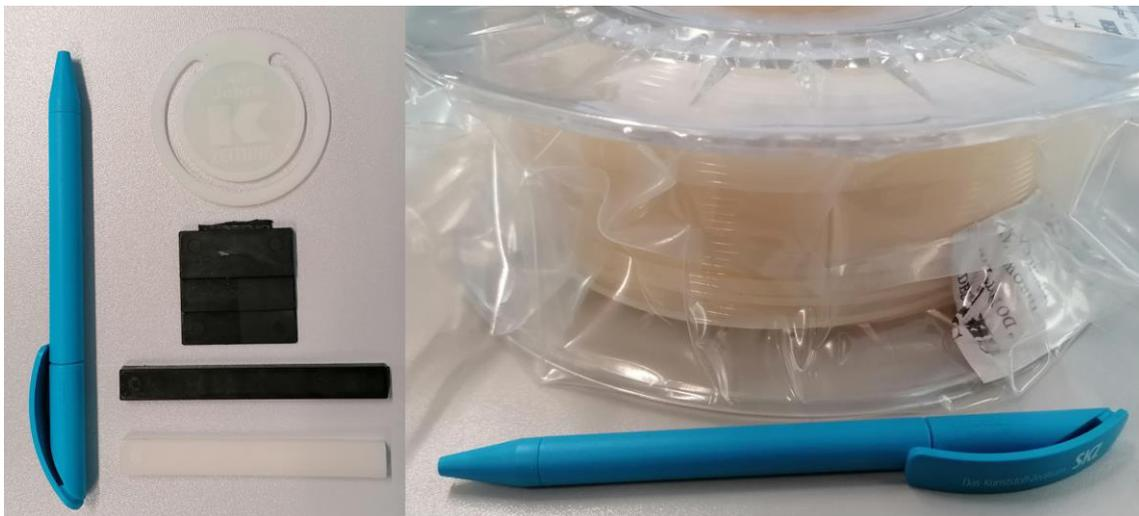
Abbildung 20: Übersicht der von den Projektpartnern Dr. Boy hergestellten Probekörpern (links) und der von HERZ hergestellten Filament-Spulen (rechts).
