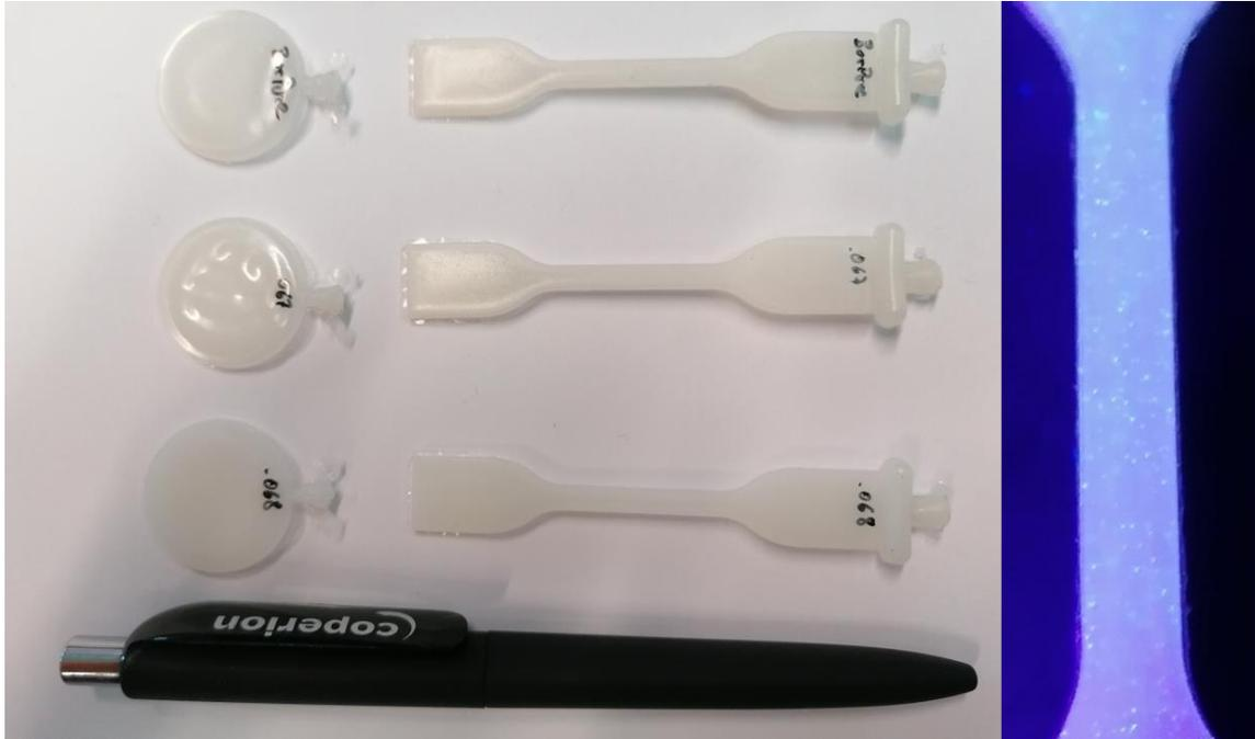
Abbildung 15: Am SKZ hergestellte Einkaufschips und Zugstäbe (Typ 5A) mit Fluoreszenzmarkern (links) und Zugstab mit UV-Licht beleuchtet (395 nm).
