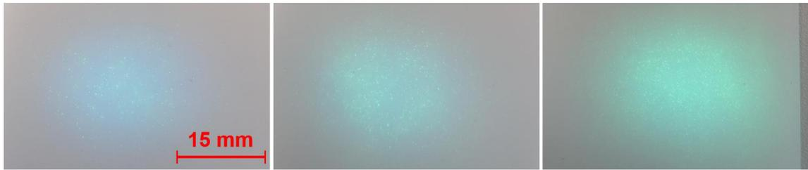
Abbildung 17: Ungefärbte Spritzgießbauteile mit geringer (links), mittlerer (Mitte) und hoher Fluoreszenzpartikelkonzentration (rechts).
