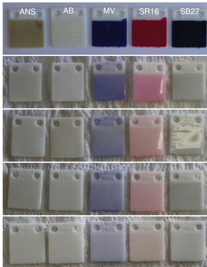
Abbildung 5.15: Mit Farbstoffen eingefärbte beschichtete Rigid 10500-Substrate nach Aufsprühen und Trocknung (1. Reihe), nach Strippen in Wasser für 15 min (2. Reihe), nach Strippen in 20%iger Aceton-Lösung für 15 min (3. Reihe), nach Strippen in 1%iger P3-Neutracare-Lösung für 15 min (4. Reihe) und nach Strippen in 50%iger Isopropanollösung für 15 min (5. Reihe).
