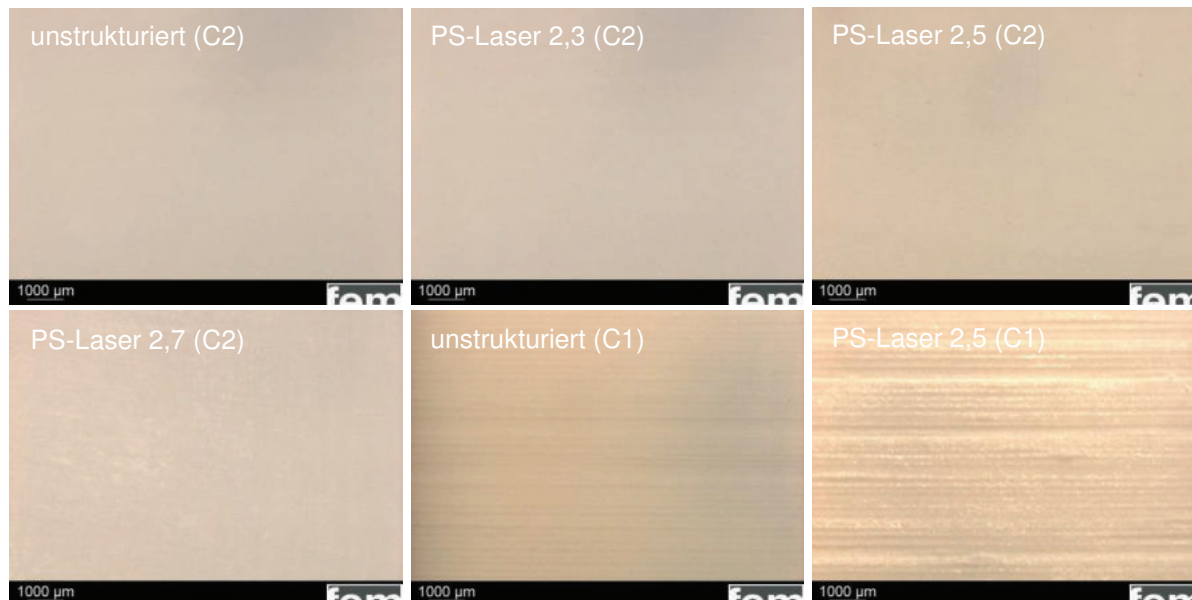
Abbildung 4.12: Lichtmikroskopische Aufnahmen von un- und laserstrukturierten Rigid 10500-Substraten der Charge 1 und 2.
