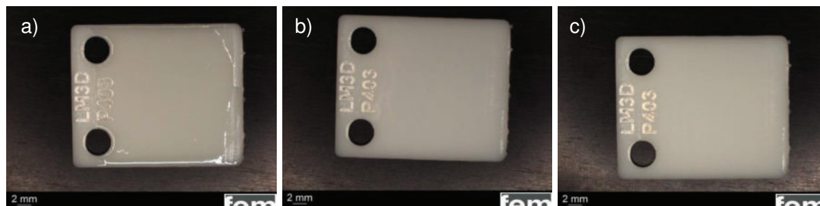
Abbildung 5.7: Beschichtetes Rigid 10500-Substrat (2 %m/v Pd(acac) 2 ); a) nach Aufbringung und Trocknung, b) nach Strippen in Wasser und 20%iger Acetonlösung und c) nach Metallisierung.
