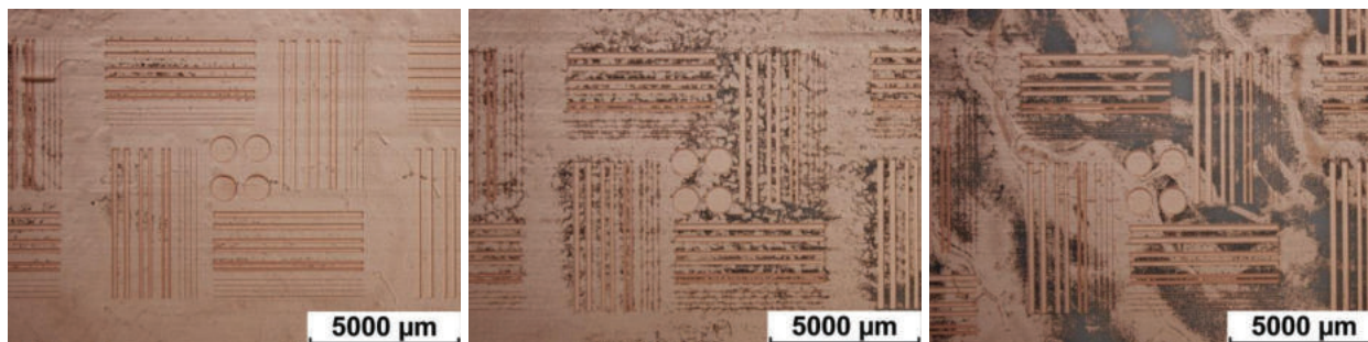
Abbildung 4.19: Variation der Verweildauer im Beschleunigerbad bei geringer Spülintensität mit mittlerer Aktivität des Kupferelektrolyten, v.l.n.r.: 1 min, 3 min und 6 Minuten
