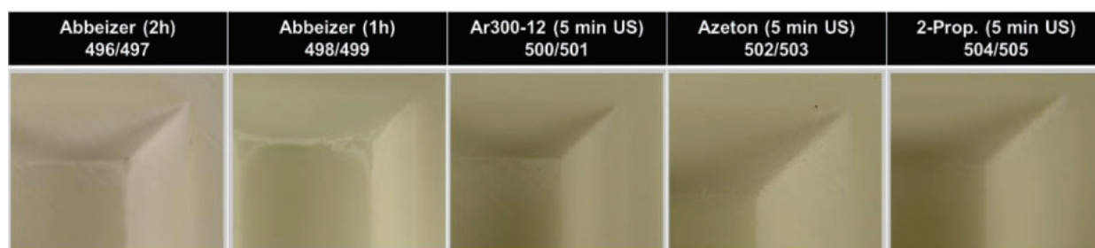
Abbildung 3.3: Verunreinigung durch abgelagerte Füllstoffpartikel auf 3D-Bauteilen nach Reinigung mit unterschiedlichen Lösungsmitteln im Ultraschallbad. Alle Bauteile wurden im Anschluss mit Wasser im Ultraschallbad nachbehandelt.
