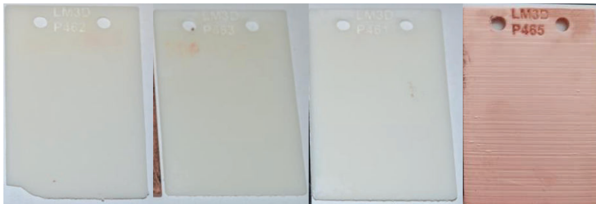
Abbildung 4.18: Plattensubstrate nach Aktivierung und Metallisierung, Aktivatoren v.l.n.r.: Adhemax Activator SF, Doduprint 470 S und Enplate LDS PD, Enplate Activator 850
