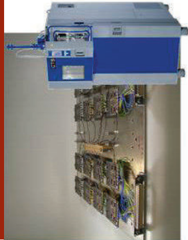
Online-Widerstands-messung zur Bestimmung des Ausfallzeitpunkts im Temperaturschocktest
