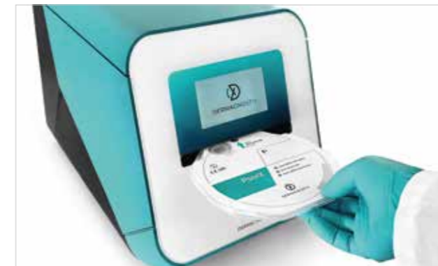
Das handliche Laborgerät prozessiert die Disk durch Rotation, Heizen und Kühlen. Die Nachweisreagenzien sind auf der Disk vorgelagert und öffnen sich entsprechend der Drehfrequenz.
