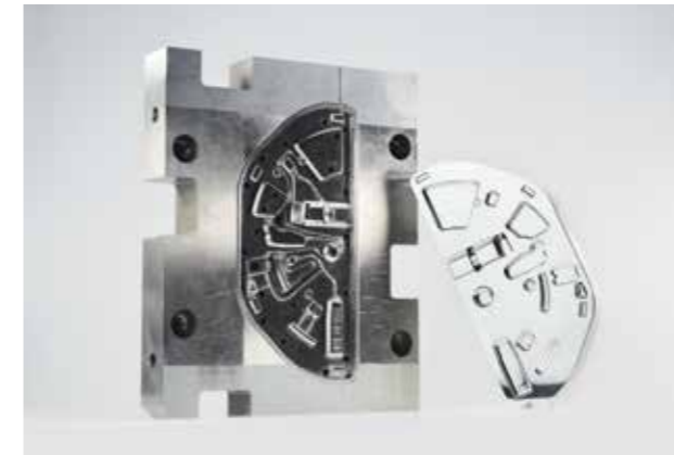
Spritzgusswerkzeug-Einsatz mit Präzisionsoberflächen und Mikrostrukturen.
