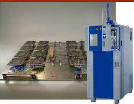
Online-Widerstandsmessung zur Bestimmung des Ausfallzeitpunkts im Temperaturschocktest
