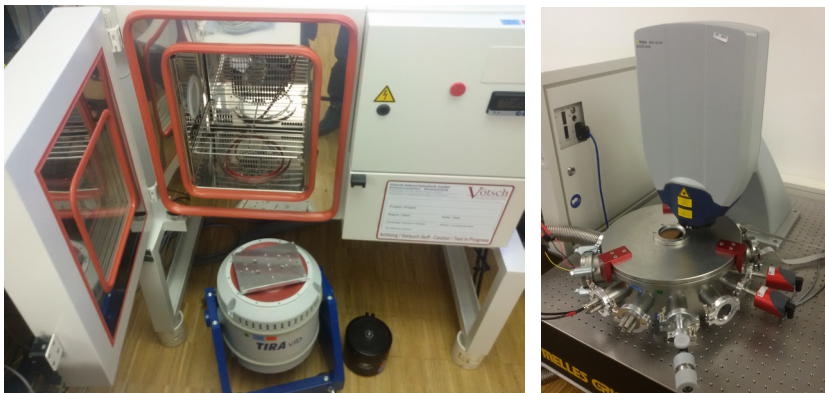
Abb. 2: Schwingungserreger mit Temperaturkammer (links) und Laservibrometer mit zugehöriger Vakuumkammer (rechts) für die mechanische bzw. optische Schwingungsanalyse.
