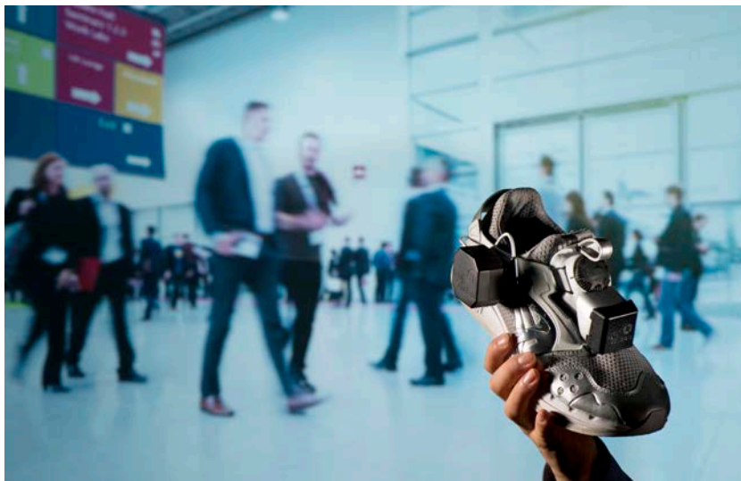
Abb. 1: Die inertielle Sensoreinheit sitzt vorne am Schuh, der Harvester seitlich.
