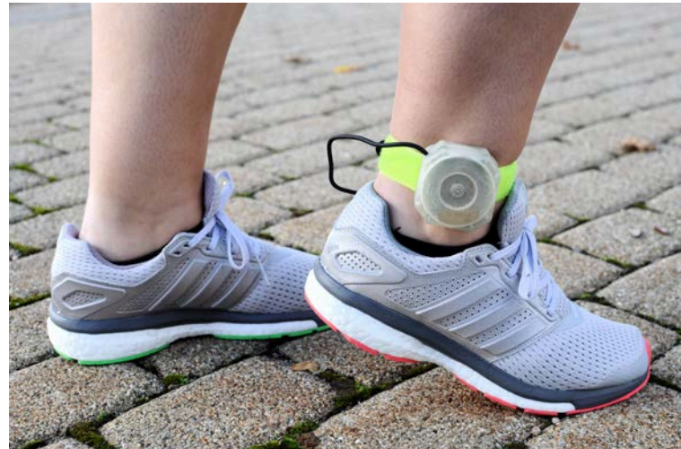
Abb. 1: Am Knöchel zu tragender Pendel-Harvester für menschliche Bewegungen. Per Kabel wird die elektrische Energie z.B. für ein Indoor-Navigationsmodul bereitgestellt, welches am Schuh sitzt und zur Lokalisierung innerhalb von Gebäuden verwendet wird.
