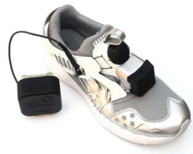
Abb. 2: Harvester am Knöchel versorgt per Draht ein Sensormodul am Schuh mit Energie
