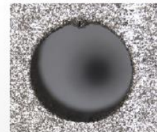
Schlackenbildung in nach unten gerichteten Flächen.
