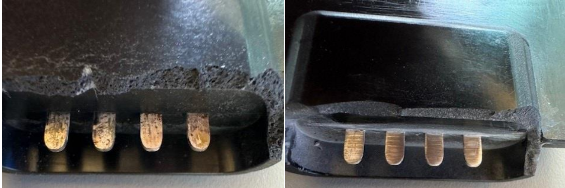
Abbildung 23: links: Bauteil mit gefrästen Einsätzen hergestellt; rechts: Bauteil mit gedrucktem Einsatz und konturnaher Temperierung hergestellt
