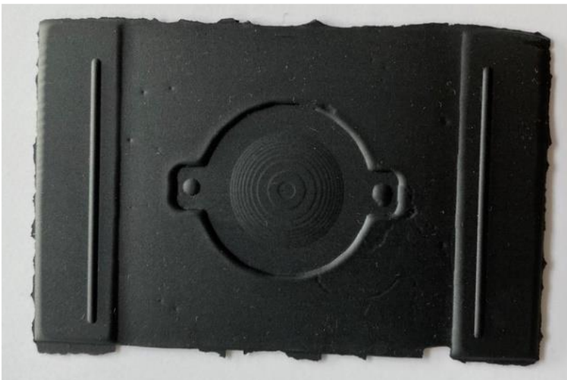
Abbildung 21: Bauteil aus FAM mittels gedruckten Einätzen
