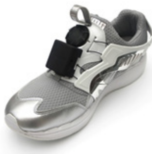
Abb. 2: Indoor-Navigation am Sportschuh. Das Energy-Harvesting-Modul ist in der Sohle integriert. Quelle: Hahn-Schickard
