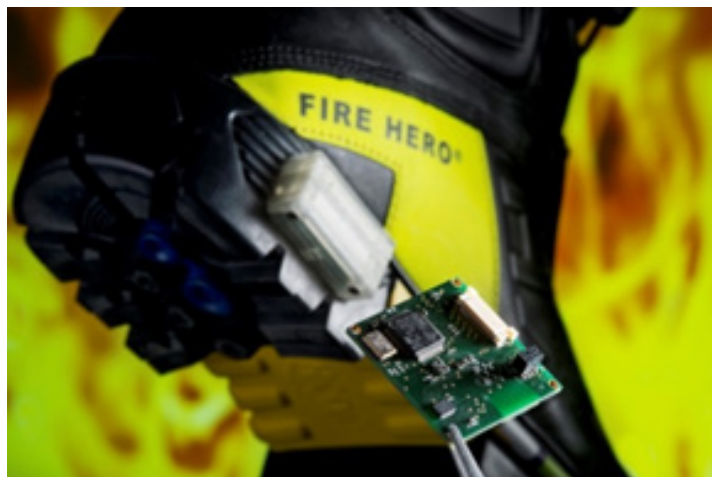
Abb. 1: Integriertes Sensorsystem zur Positionsbestimmung innerhalb von Gebäuden. Quelle: Bernd Müller für Hahn-Schickard
